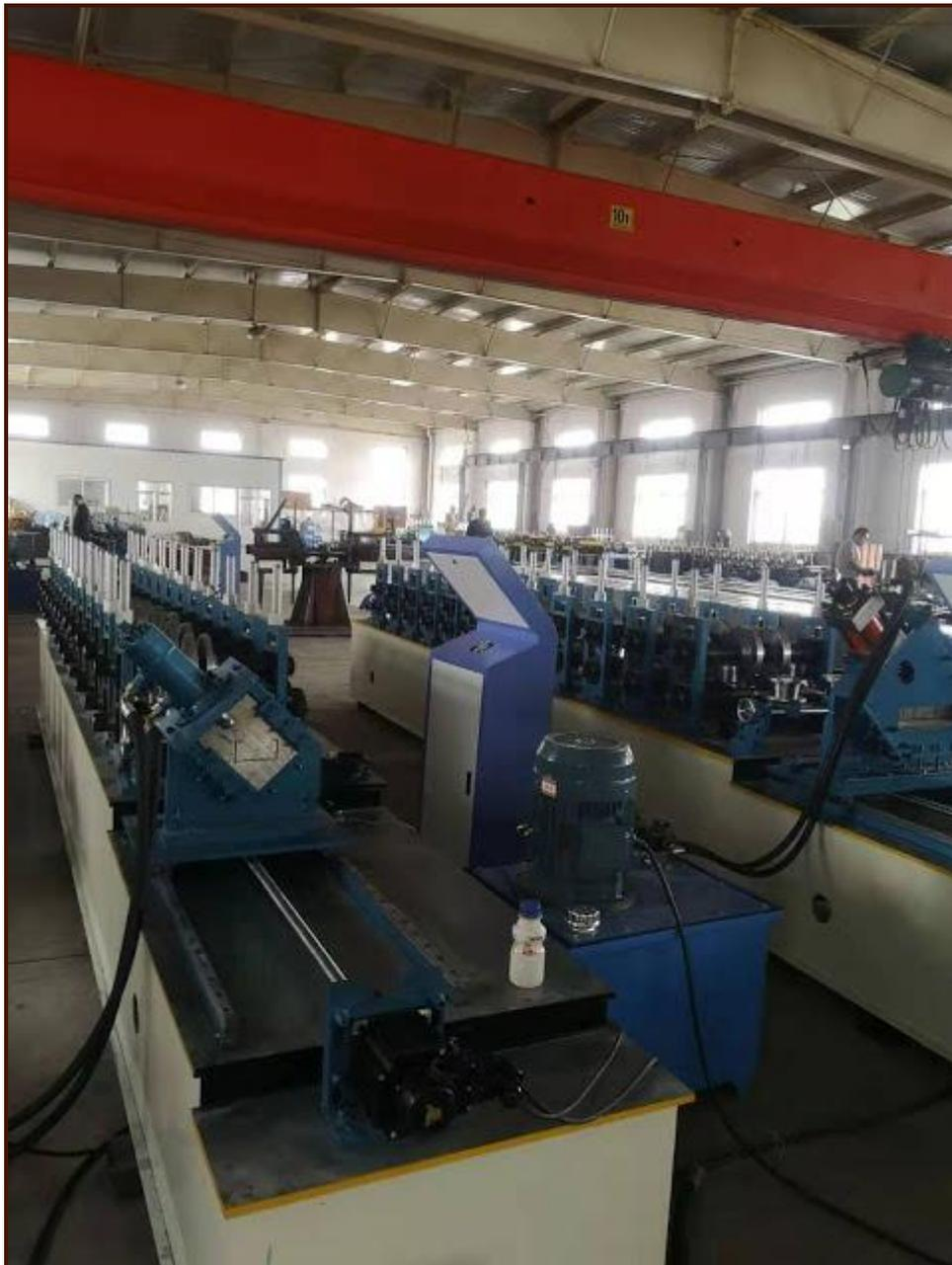
Perfiles de acero livianos hechos por proceso de máquina de perfilado, como canal u, canal c, etc., piezas de acero para el marco de la estructura del edificio.
