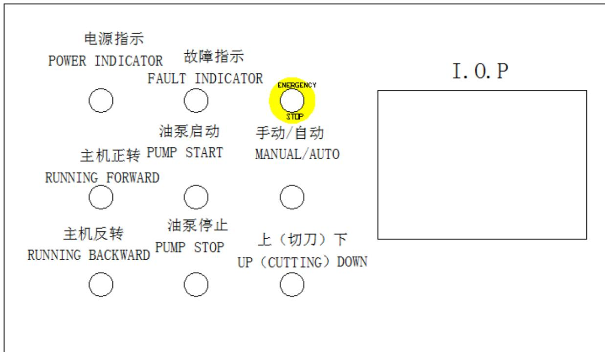
La disposición de los elementos de control en la consola.
